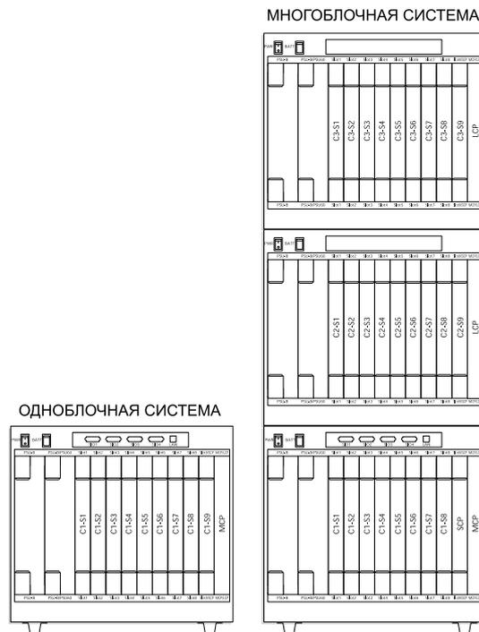
Рис. 10-1 Нумерация блоков и слотов.
