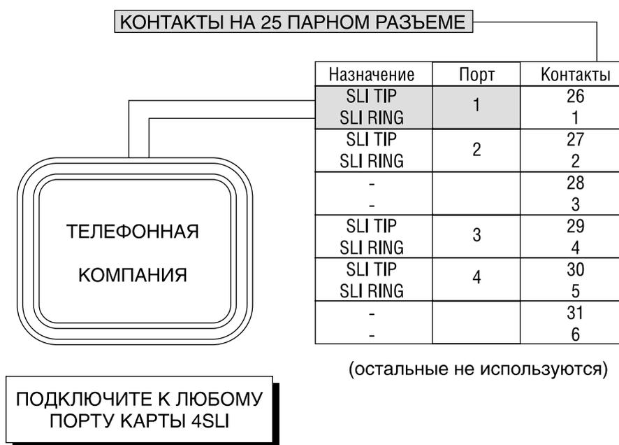
Рис. 5-4 Подключение линий OPX к карте SLI
