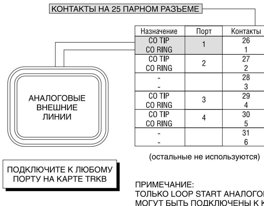
Рис. 5-1 Подключение внешних линий к карте TRKB
