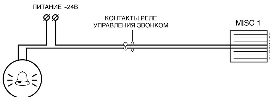
Рис. 7-3 Подключение совместного звонка
