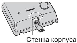
2. Пропустите провода сквозь отверстие в основании корпуса и прикрепите основание корпуса к стене 2 винтами.
