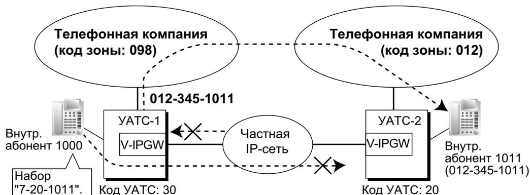
Первые цифры внутренних номеров, доступных по сети передачи речи через протокол IP, добавляются в таблицу номеров быстрого набора, а также регистрируются как внутренние номера другой УАТС, как описано ниже:
