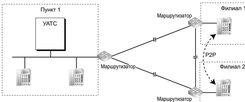
Вызовы между IP-телефонами в отдельных филиалах образуют P2P-соединение непосредственно через маршрутизаторы виртуальной частной сети в каждом филиале.
