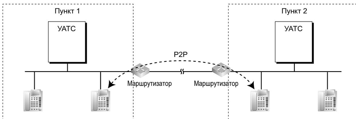
Вызовы между телефонами, находящимися в отдельных пунктах, каждый из которых имеет собственную УАТС, образуют P2P-соединение по виртуальной частной сети.
