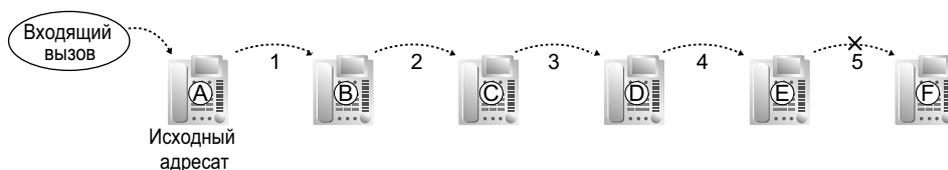
На иллюстрации выше переадресация вызовов останавливается на внутреннем абоненте E. Однако она может быть продолжена в следующих случаях:
