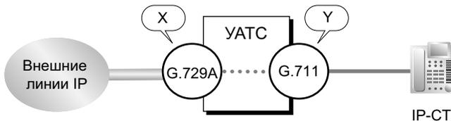
Если вызов по IP-внешней линии с использованием кодека G.729 требует количество ресурсов X, а вызов по IP-внутренней линии с использованием кодека G.711 требует количество ресурсов Y, в этом случае количество ресурсов, требуемых для вызова IP-внутренней линией IP-внешней линии требуется количество ресурсов X + Y.
