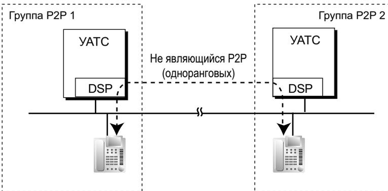
Назначение групп YATC используется, когда IP-телефон устанавливает соединение с телефоном, не являющимся IP-телефоном (например, ТА). Если YATC телефона, не являющегося IP-телефоном находятся в одной и той же группе P2P, между IP-телефоном и YATC устанавливается P2P соединение:
