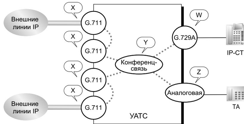
Конференц-связь требует дополнительных ресурсов,  $Y$ , для обработки множественных речевых каналов. Кроме того, при стандартном двустороннем разговоре аналоговые линии обычно не требуют каких-либо ресурсов DSP, но при конференц-связи эти ресурсы необходимы. Дополнительно IP-внешние линии при конференц-связи требуют дополнительных ресурсов DSP. Таким образом, требуемое количество ресурсов в данном примере составляет  $X + X + X + X + Y + Z + W$ .
