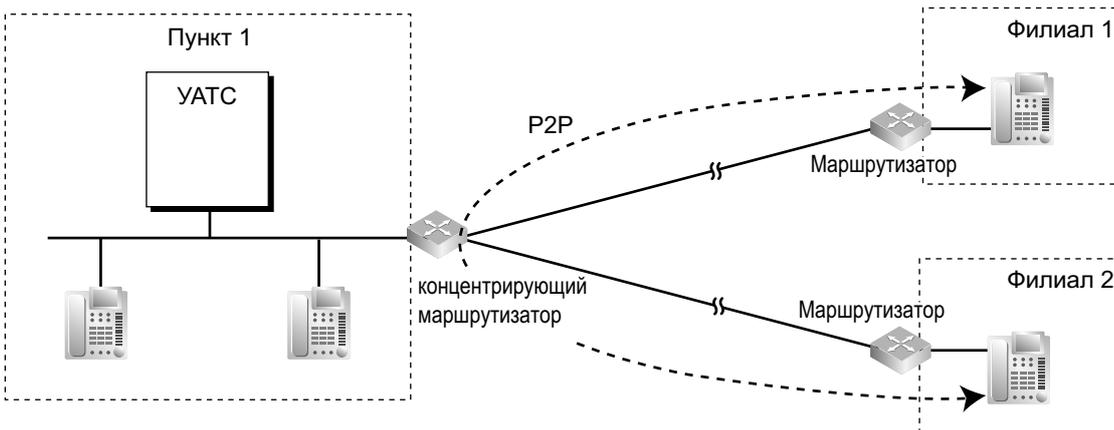
Вызовы между IP-телефонами в отдельных филиалах образуют P2P-соединение через концентрирующий маршрутизатор в Пункте 1, который используется для связи по частной виртуальной сети.
