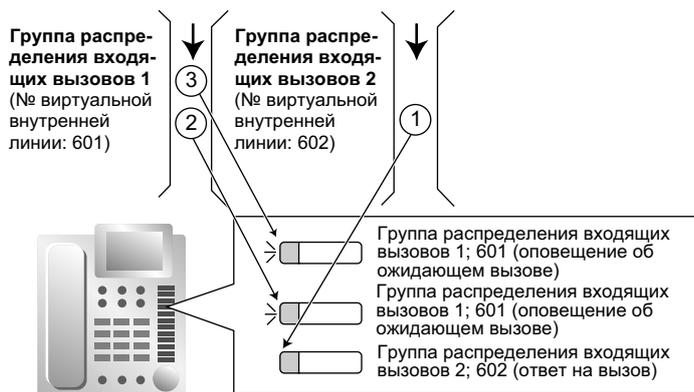
**3. Перенаправление при отсутствии ответа (способ "Равномерное распределение вызовов" или "Поиск по приоритету")**
