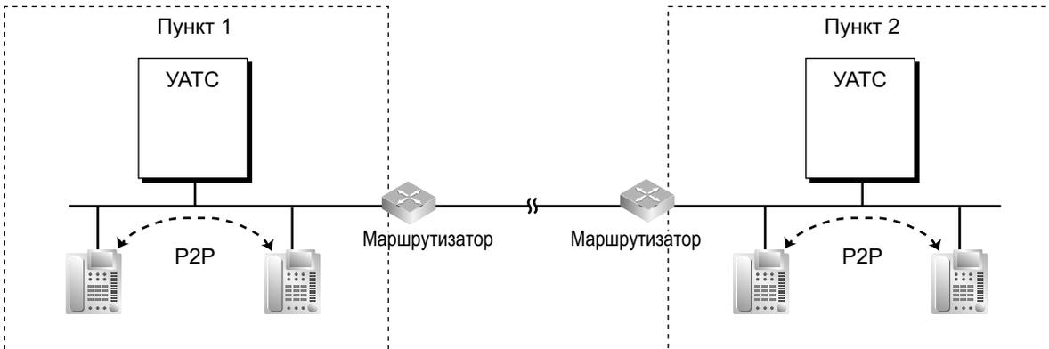
Вызовы между IP-телефонами в пределах пункта создают P2P-соединение.
