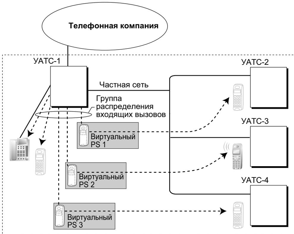
На каждом виртуальном PS устанавливается постоянная переадресация вызовов на внутренний номер фактического PS, зарегистрированного в одной из других УАТС.
