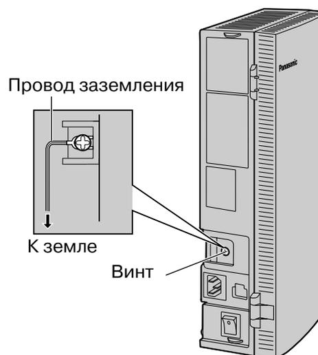
\* Используйте провод заземления с поперечным сечением проводника не менее 0,75 мм<sup>2</sup> или 18 AWG. Провод заземления должен иметь зеленую с желтым изоляцию.
