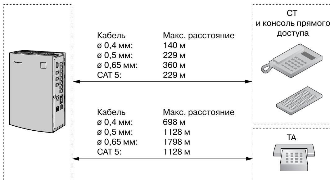
Для каждой внутренней линии необходимо 2- или 4-проводное подключение, как показано ниже. Для подключения могут использоваться 4 контакта: "Т" (провод а), "R" (провод б), "Н" (высоковольтный) и "L" (низковольтный).
