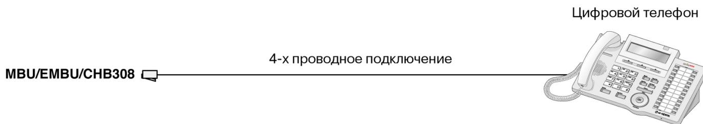
Рис. 5.1.2.1 Подключение цифрового аппарата и консоли DSS
