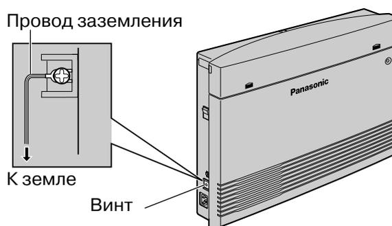
\* Используйте провод заземления с поперечным сечением проводника не менее 0,75 мм<sup>2</sup> или 18 AWG. Провод заземления должен иметь зеленую с желтым изоляцию.
