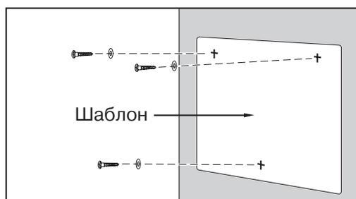
2. Просверлите отверстия в стене в отмеченных местах и вставьте дюбели (в комплект поставки не входят) в отверстия.
