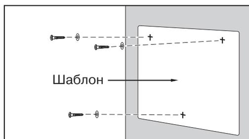
2. Наденьте на винты шайбы и заверните винты в стену.
