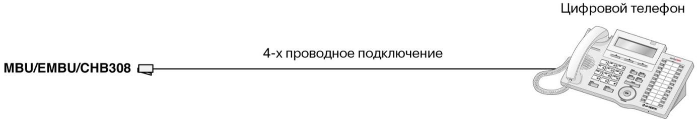
Рис. 2.21 Подключение цифрового аппарата и консоли DSS
