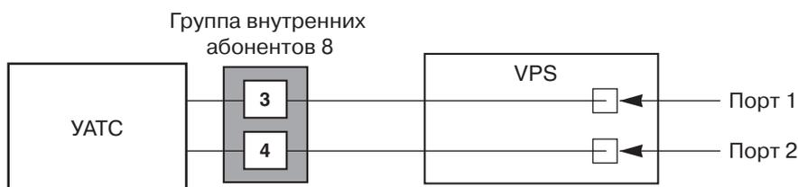
В данном примере использована система VPS Panasonic KX-TVM50/KX-TVP50, которая может быть подключена 2-проводным кабелем к 2 разъемам внутренних линий УАТС.
