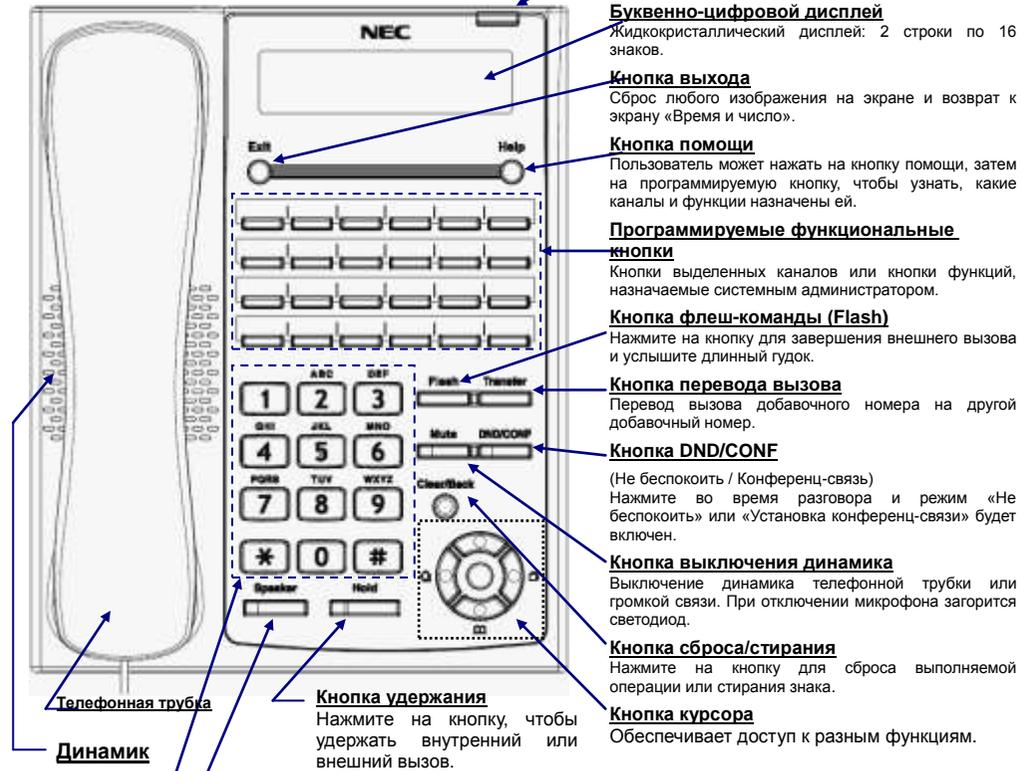
\* Модель IP4WW-12TXH-A TEL имеет 12 программируемых функциональных кнопок.
